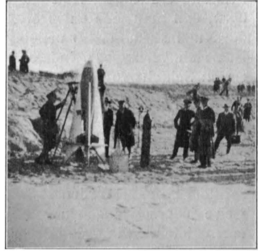
Abb. 33 Stimmungsbild von den Startvorbereitungen auf der Nehrung: die Teilnehmer. In der Mitte die Stahlflasche für komprimierten Stickstoff zum Durchblasen der Hohlräume zur Verhinderung von Knallgasansammlungen und zum Hinausdrücken des flüssigen Sauerstoffs beim Füllen.
